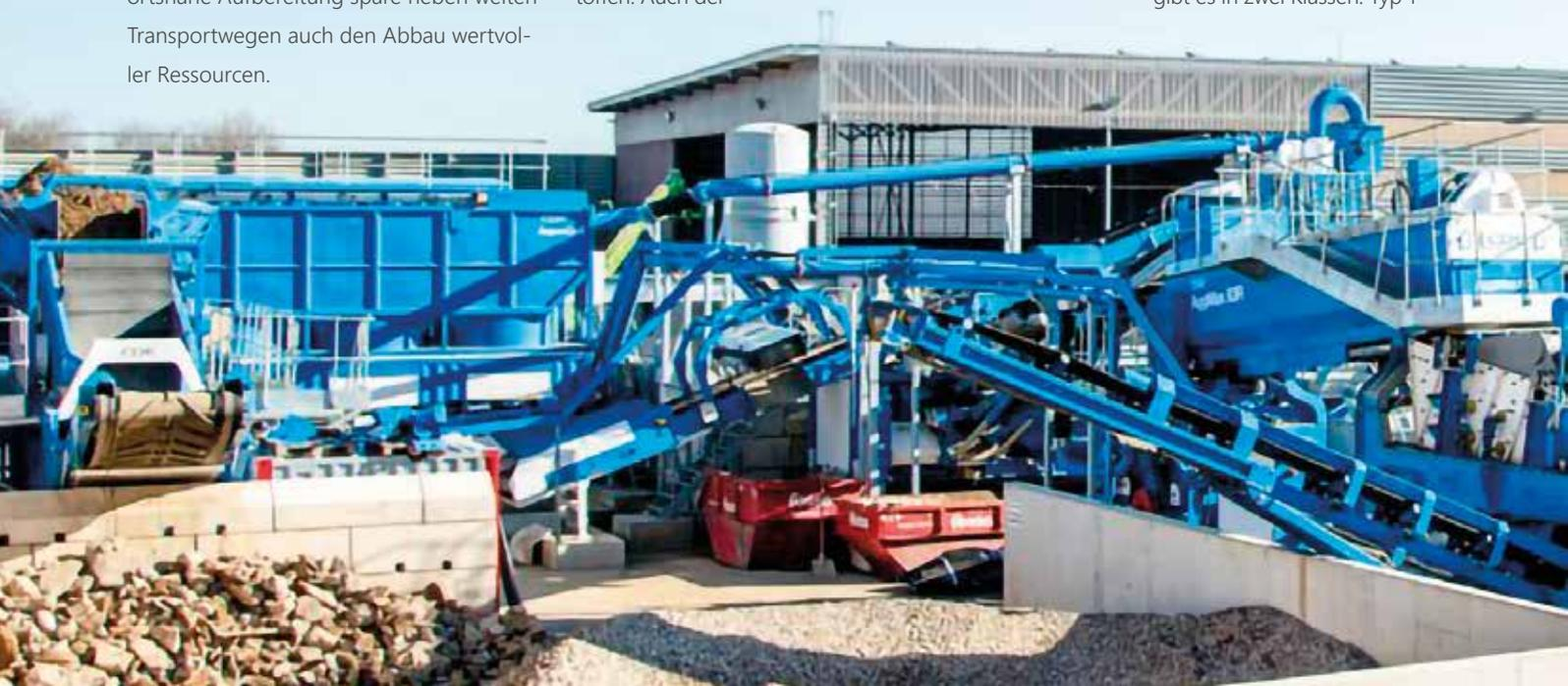
enthält 90 Prozent Beton-Recycling-Splitt und 10 Prozent sonstigen Baustoffe-Recycling-Splitt. Beim Typ 2 ist der Anteil des Baustoff-Recycling-Splitts auf 30 Prozent erhöht. Durch mehr Ziegel, Kalksand und Naturstein wirkt der Beton farbenfroher. Die Investition in eine sogenannte „Nassklassierung“ macht es Feess möglich, auch lehm- und schluffhaltige Baustoffe zu trennen und der Wiederverwertung zuzuführen.
